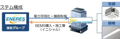
契約電力を超えることがないように、事前に警報や機器制御を実施して、電力料金の削減を実現する
